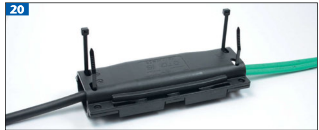
20 An beiden Seiten der Muffe je einen Kabelbinder durchschlaufen, festziehen und Überstand der Kabelbinder mit einem Seitenschneider abschneiden.
