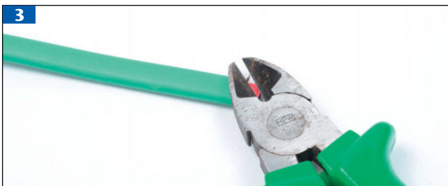
3 Schutzleiter mit dem Seitenschneider sorgfältig abschneiden.
