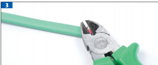
3 Schutzleiter mit dem Seitenschneider sorgfältig abschneiden.
