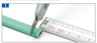
Außenmantel des Heizbandes 5 mm mit einem Kabelmesser abisolieren.
