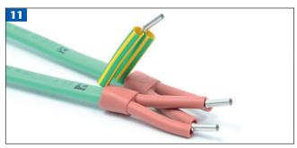
Über die stromführenden Leiter je eine Aderendhülse 4,0 mm² aufschieben und eine passende Aderendhülse über Schutzgeflecht aufschieben.
