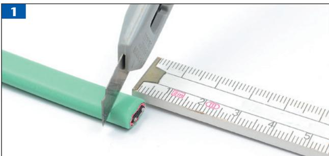
Außenmantel des Heizbandes 5 mm mit einem Kabelmesser abisolieren.
