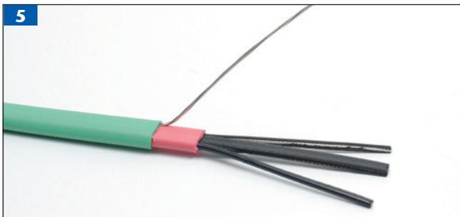
5 Schwarze Heizmatrix mit Abisolierzange vorsichtig abziehen und Kupferleiter freilegen.
