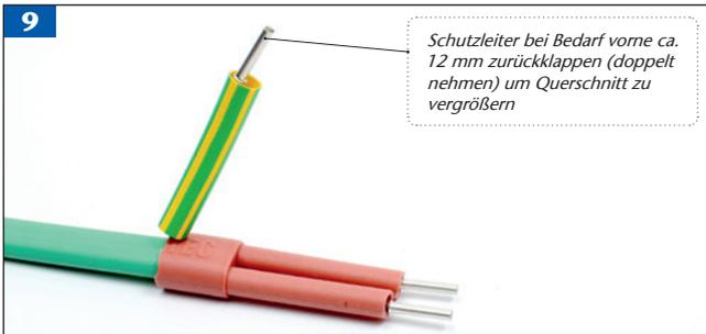
Über die beiden stromführenden Leiter je eine Aderendhülse 1,5 mm<sup>2</sup> aufschieben und eine passende Aderendhülse über Schutzleiter aufschieben.
