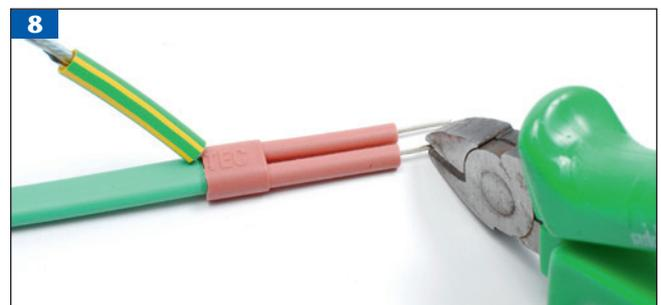
8 Alle Adern mit dem Seitenschneider auf 12 mm und gleiche Länge einkürzen.
