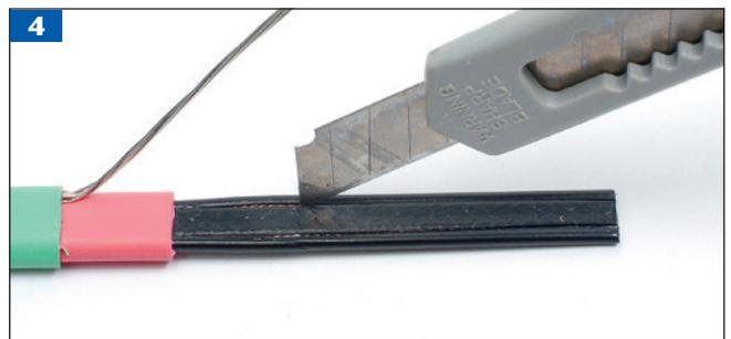
4 Schwarze Heizmatrix entlang der Kupferleiter an der Vorder- und Rückseite mit einem Kabelmesser aufschneiden.
