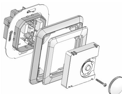
Um den Einstellbereich einzuschränken, wird der sich unter dem Einstellknopf befindliche Stift abgezogen und die Einstelfahnen verstellt (rot für maximal und blau für minimal mögliche Einstellung). Anschließend wird der Stift wieder eingesteckt und somit die Begrenzungen arriert.
