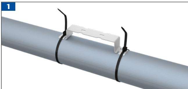
Befestigen Sie den Abstandshalter mit Kabelbindern am Rohr.
