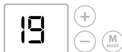
Falls statt der Temperatur « **FF** » angezeigt wird ist eine Korrektur nicht möglich (dies geschieht wenn die Temperaturdifferenz größer als 3°C ist oder falls sich die Komforttemperatur unter 17°C oder über 23°C befindet).
