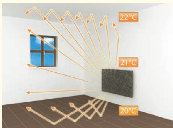
Gleichmäßiges Raumklima ohne Aufwirbelungen durch Strahlungswärme (Infrarotstrahlung) bei den Halmburger Infrarot-Marmor- und Natursteinheizungen
