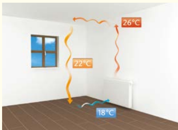
Temperaturverlauf und Thermik bei herkömmlichen Konvektions-Heizsystemen
