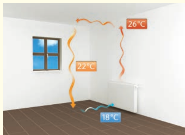
Temperaturverlauf und Thermik bei herkömmlichen Konvektions-Heizsystemen
