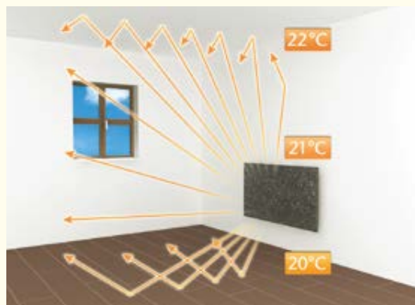
Gleichmäßiges Raumklima ohne Aufwirbelungen durch Strahlungswärme bei der Halmburger Infrarot-Marmor- und Natursteinheizung
