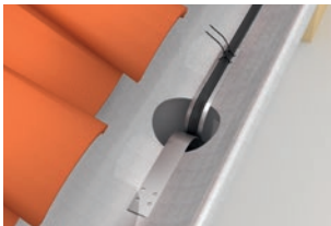
Kantenschutz am Fallrohr zur Zugentlastung.
