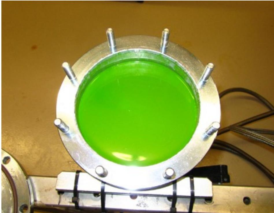
Abbildung 4: Prüfaufbau IP-Schutzartprüfung IPx8
