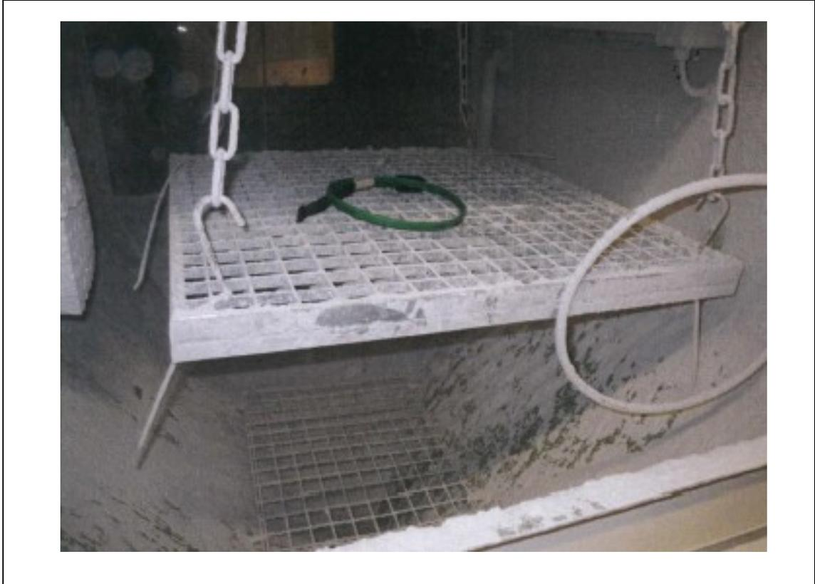
Abbildung 3: Prüfaufbau IP-Schutzartprüfung IP6x
