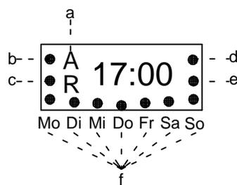
Während des Arbeitsbetriebes erscheint als ziffernmäßige Anzeige die Uhrzeit, bei der Programmierung im Wechsel auch die Absenktemperatur. Die Punkte bei b bis e erscheinen nacheinander und bedeuten
