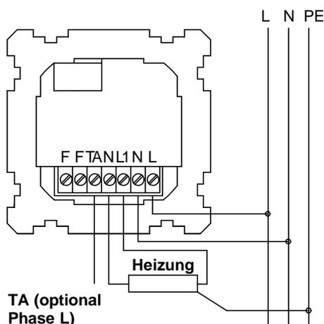
**Montage:** Der Temperaturregler wird in eine handelsübliche UP-Dose Ø 55 mm (nach DIN 49073, Teil 1) eingebaut. Beim Einsatz von zusätzlichen Zwischenklemmen empfehlen wir, eine tiefe Schalterdose zu verwenden. Der Anschluss erfolgt gemäß dem nebenstehenden Schaltplan. Die Anschlussleitungen müssen gerade und ca. 5 mm abisoliert sein. Montagehöhe ca. 1,5 m über dem Fußboden.
