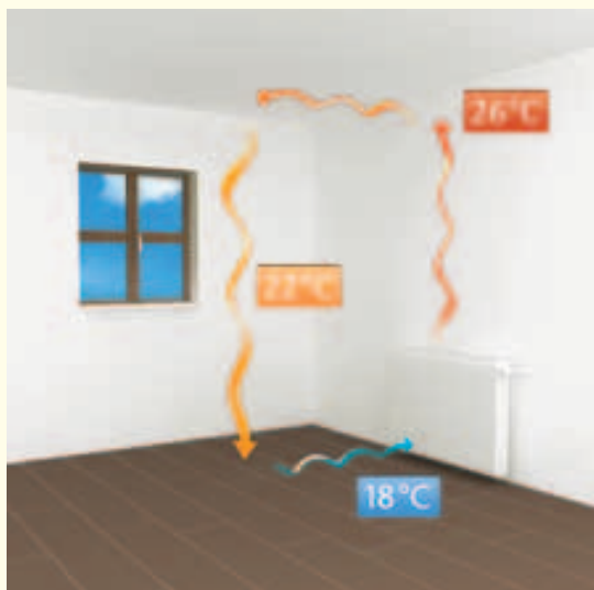
Temperaturverlauf und Thermik bei herkömmlichen Konvektions-Heizsystemen
