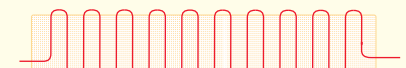
Lieferform 0,50 m breit, mit 2 Anschlussleitungen, welche je nach Bedarf von der Heizmatte abgetrennt werden
