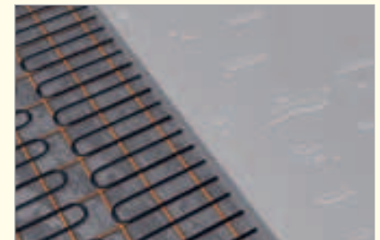
Gleichmäßiger Abtauvorgang bei geringem Verlegeabstand. Wärmeverteilung bei einem Heizleiterabstand von 60 – 80 mm bei Halmburger Freiflächenheizungen mit max. 25 W/m Heizleiterbelastung.
