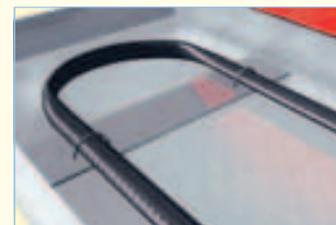
Abstandhalter bei der Doppelverlegung des Dachrinnenheizbandes.
