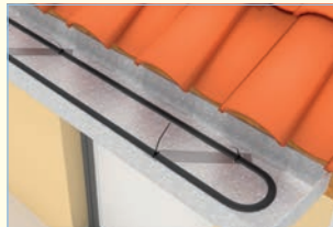
Abstandhalter bei der Doppelverlegung des Dachrinnenheizbandes.
