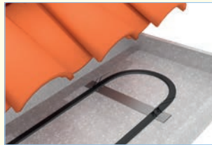
Abstandhalter bei der Doppelverlegung des Dachrinnenheizbandes.
