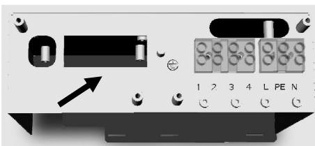
Programmierschnittstelle im Elektroanschlussraum
